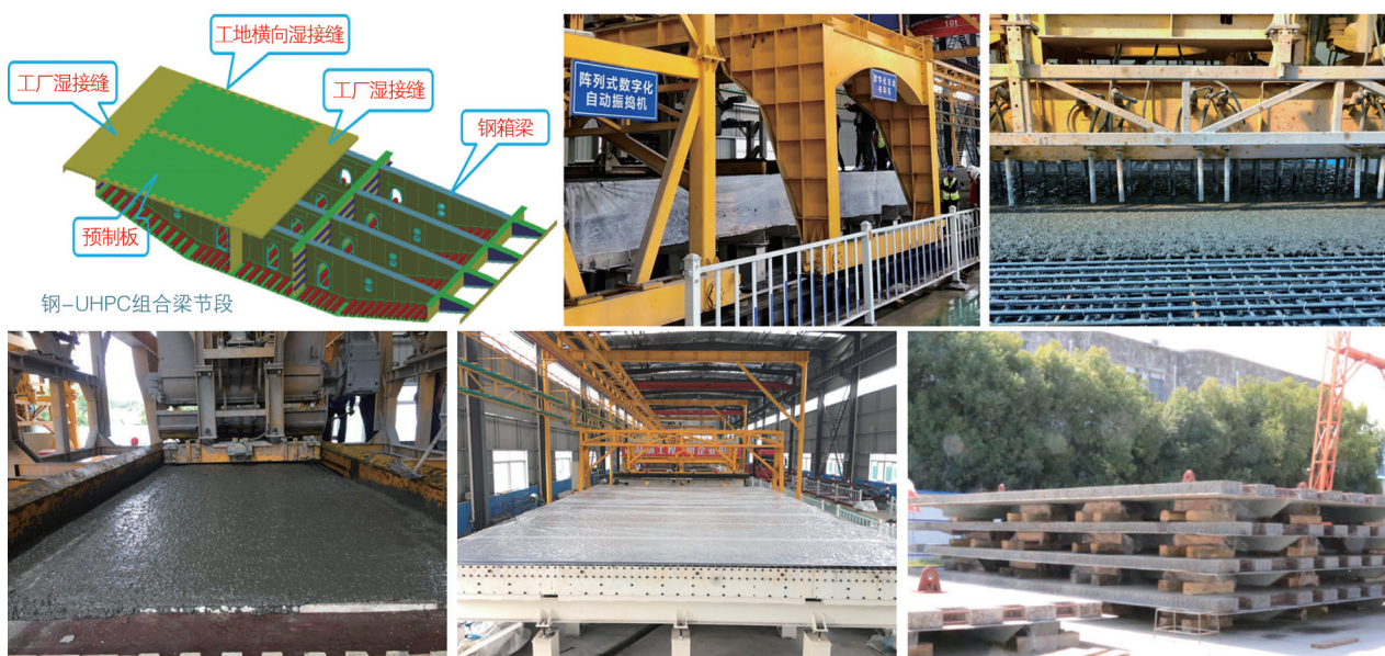
图5 南京长江五桥钢-UHPC组合梁示意图、UHPC桥面板预制生产线(中交二航提供照片)
